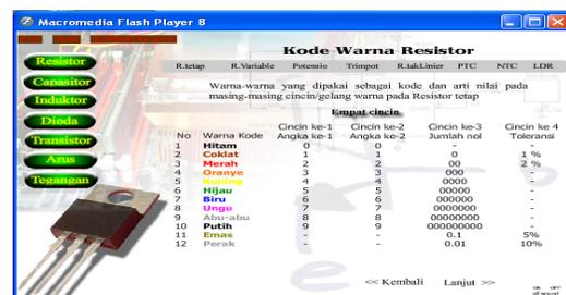
Gambar:3. Tampilan Menu Kode warna Resistor
